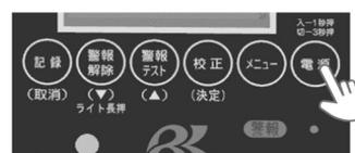
ブザーが“ピーピーピー”と 3 回鳴り、本体 LCD に「電源オフ」と表示され、電源が切れます。
