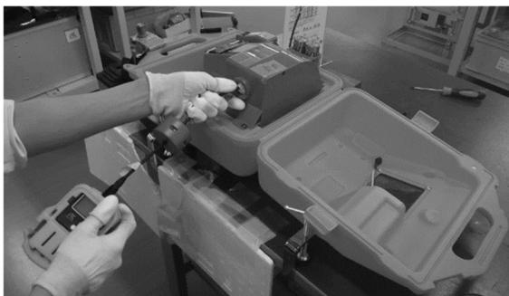
コードリール本体を固定して先端の検知部をもってケーブルを引き出します。
