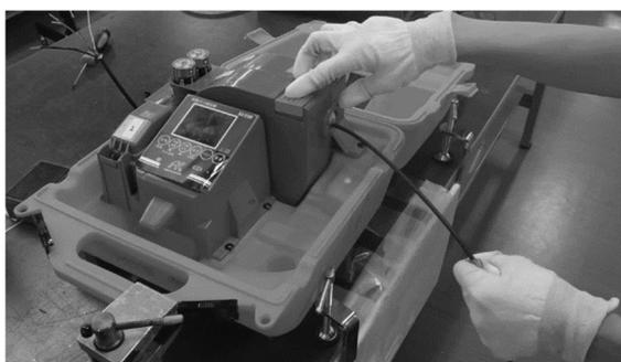
ケーブルを片手でガイドしながら、自動巻き取りリール上部にある収納用ボタン(黄色)を押して巻き取ります。
